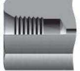
**V** - VacuSeal-Anschluss mit Gleitringdichtung
