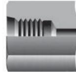
**KM** - British Standard BS 21 (ISO 7-1), Außenrohrgewinde
